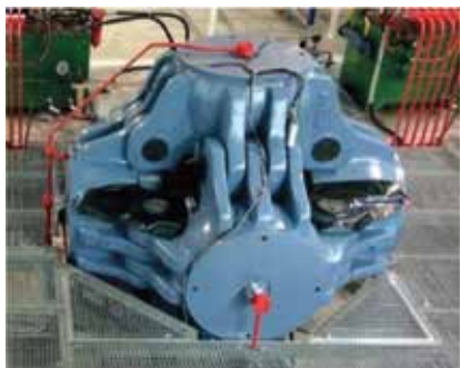
Der Diamant wächst in der Hochtemperatur-Hochdruckpresse bei 1'800 Grad und 70'000 bar Druck.
