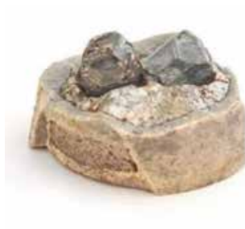
Nach dem Öffnen der Wachstumszelle wird der Diamant gereinigt und zum Schleifen vorbereitet.
